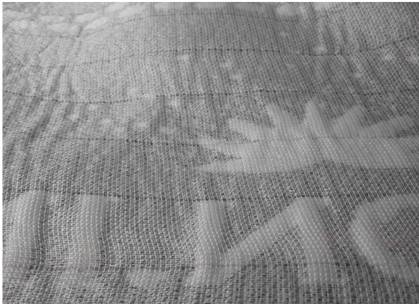
Aspecto de la muestra TEJIDO ORGON.INK® estudiada, en su cara interior con las inserciones de hilos metálicos.
